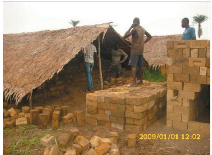
*Getrocknete Ziegel bilden einen Ofen, werden mit Schlamm bedeckt und gebrannt, als Qualitätstest.*
